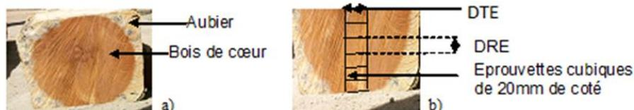
**Figure 1** : Mode de prélèvement des éprouvettes, a) Madrier fraîchement coupé, b) Découpage des éprouvettes
